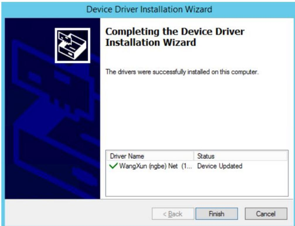
单击 'finish' 完成驱动加载。在设备管理器 Device Manager 查看以太网控制器 Ethernet Controller，可以看见驱动已成功加载。
