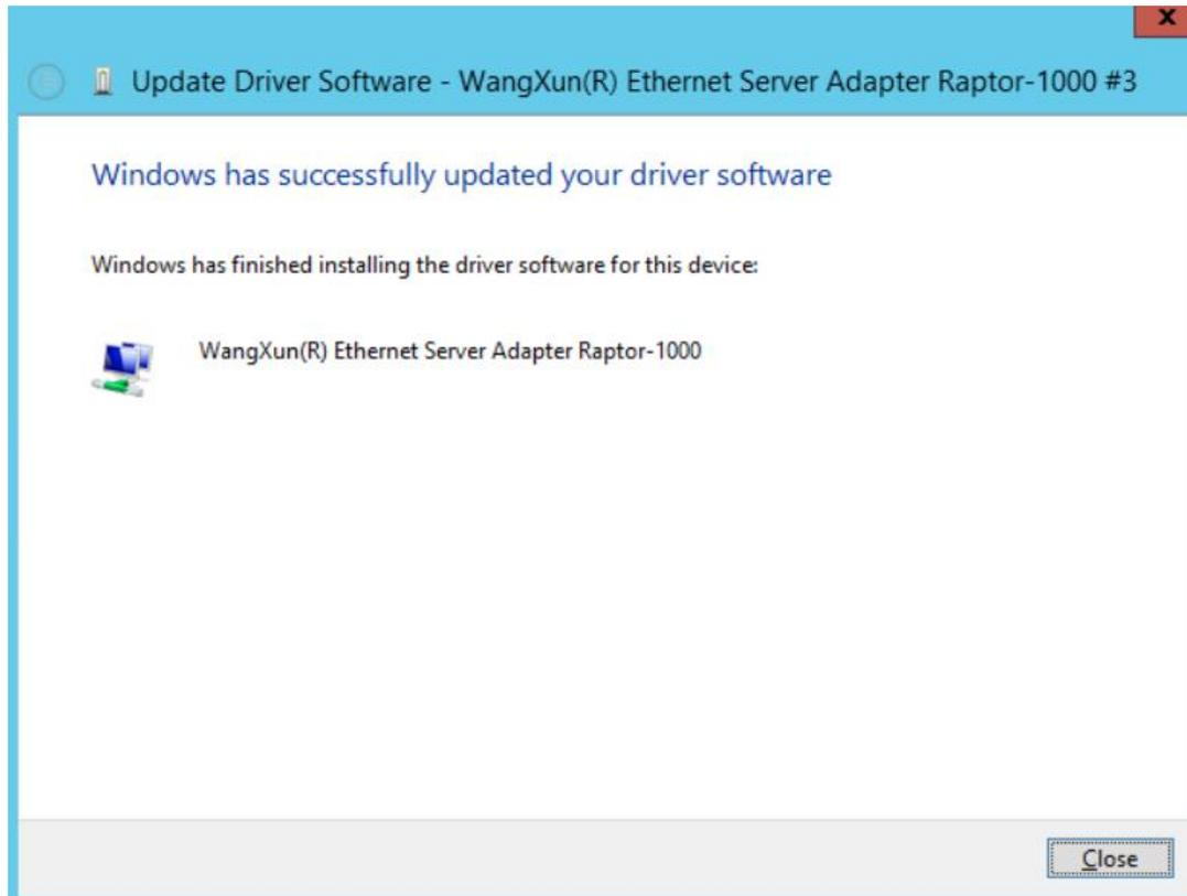
查看设备管理器，可发现在网络适配器 Network Adapters 中万兆网卡成功加载，并显示为 Wangxun(R) Ethernet Sever Adapter Raptor-1000。
