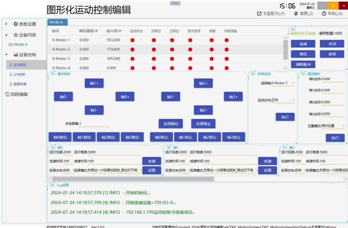
2. I/O 控制: 可调试已经添加的运动卡的输出信号, 可实时显示输入信号的状态,
