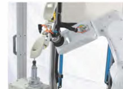
车门把手、方向盘三幅等汽车内外饰塑胶件的打磨抛光
