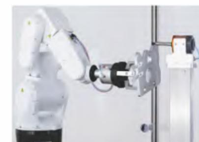
铸铁成型件、铝镁合金压铸件、钢制机加工件的打磨去毛刺
