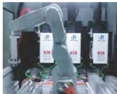
电子产品玻璃盖板加工的精雕机上下料
