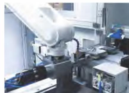
汽车直线导轨的不同端面的倒角、去毛刺
