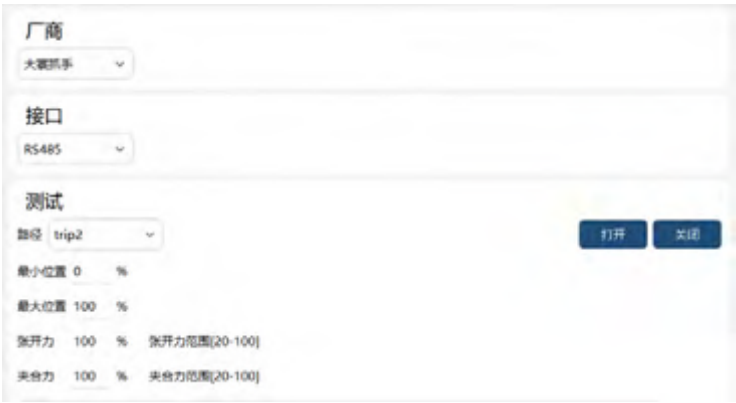
末端工具 RS485 接口配置
